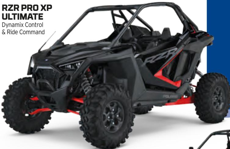
Sa plate-forme présente un gabarit de 1,62 m de large, des suspensions de 500 mm de débattement à l'avant et 550 à l'arrière, assurant une garde au sol de 368 mm favorisée également par des roues de 30 pouces.
