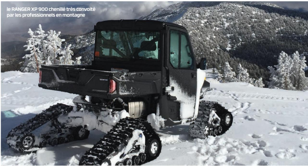
MOTOR 73 s'est taillé une solide réputation dans le secteur avec le RANGER pour équiper des professionnels dans sa version chenillée avec cabine chauffée l'hiver permettant de transporter du personnel (Ranger Crew 6 places), emporter et tracter du matériel puis de le remettre sur roues aussitôt la saison terminée et ainsi l'exploiter 12 mois sur 12, ce qu'une motoneige ne permet pas.
