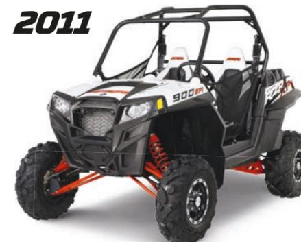
RZR 900 XP - Nouveau châssis, suspensions arrière à bras tirés et moteur ProStar
