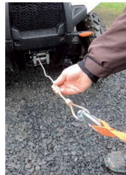
**Traction :** Si vous possédez un treuil et l'avez utilisé durant votre sortie, pensez à le re-dérouler entièrement pour bien nettoyer le câble et l'enrouler correctement sur toute la surface du rouleau (de gauche à droite et inversement) en le maintenant en tension.
