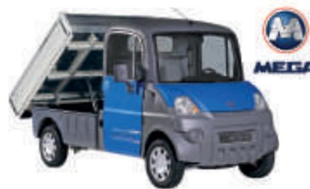
autonomie allant jusqu'à 110km selon le choix des batteries et les conditions d'utilisation. Il offre une charge utile : de 600 à 850kg. Sa largeur varie de 1,28 m à 1,33 m selon les types de carrosseries et aménagements en fourgon rigide ou bâché, isotherme, plateau fixe ou basculant à ridelles (amovibles et rabattables, benne à déchets, équipement nettoyage/arrosage. Le Multitruck d'un gabarit supérieur et facilement identifiable par sa cabine type fourgon, existe en version ther-
