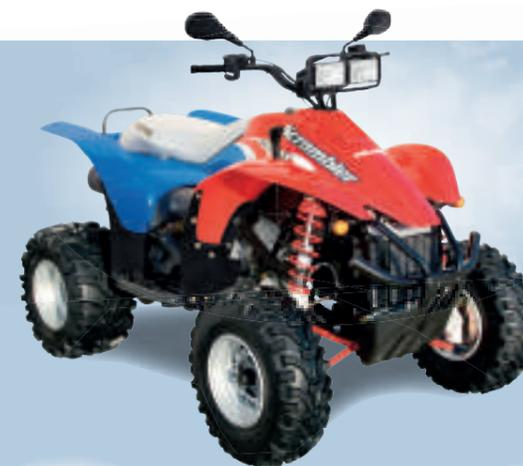
**1995 :** Le Scrambler 400 passe en quatre roues motrices par l'ajout d'une transmission avant par pignons à renvoi d'angle, d'une chaîne et de 2 cardans.
