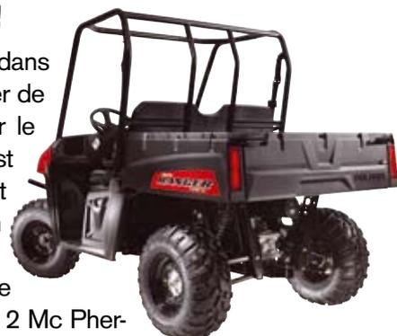
Ranger 400 reçoit, 4 suspensions indépendantes dont 2 Mc Pherson à l'avant, une transmission 4x4 débrayable en 2x4 avec différentiel arrière
